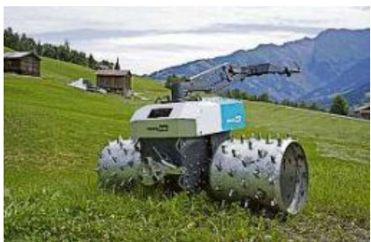
Der Monotrak ist ein elektrisch angetriebener Einachser für den Einsatz in der Landwirtschaft. Pressbild
